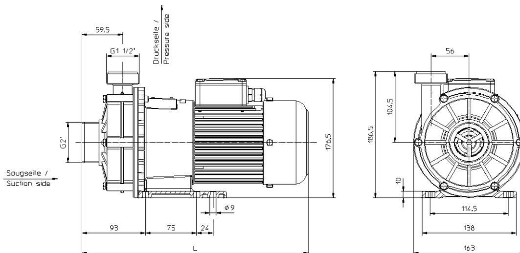
**Motorleistung 0,75kW – 1,1kW 2-pol.**
